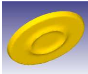
Рис.2. Напівфабрикат після штампування обкочуванням
