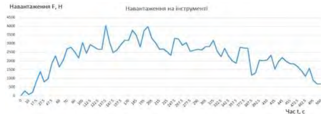
Рис. 5. Навантаження на інструменті по осі X та Y
