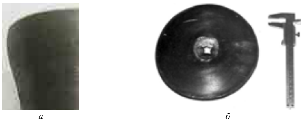
Рис. 3. Прояв характерних особливостей пластичних деформацій у вигляді радіального стовщення або стоншення і руйнування центральної частини заготовки при осаджуванні обкочуванням циліндричного зразка:
