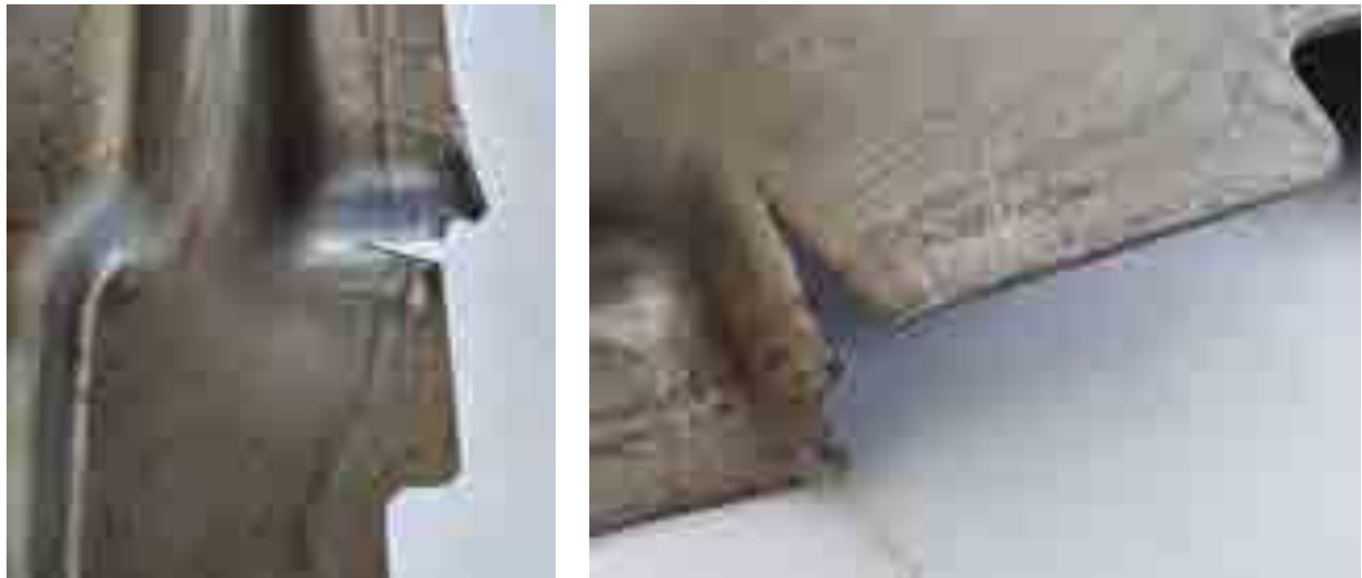
Рис. 1. Характер руйнування вихідної заготовки при деформуванні
