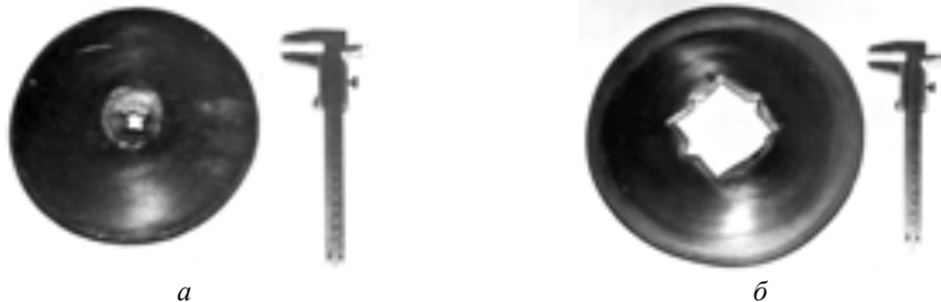
Рис. 2. Свинцевий циліндричний зразок після осаджування обкочуванням: а – на 87 % висотної деформації; б – на 95 % висотної деформації
