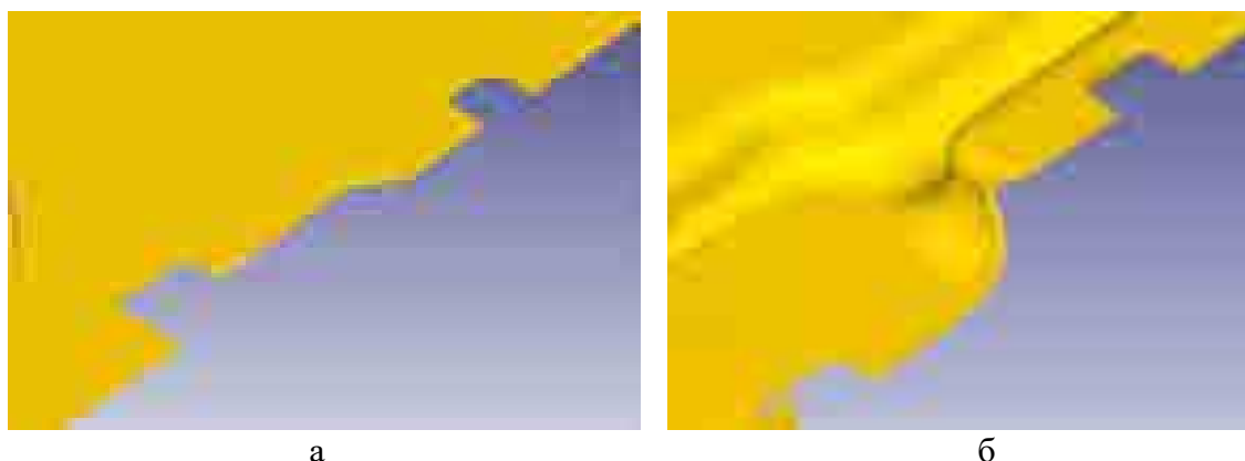
Рис. 5. Моделювання деформування заготовки зі скорегованою геометрією: а – елемент контуру заготовки; б – zdeформований напівфабрикат
